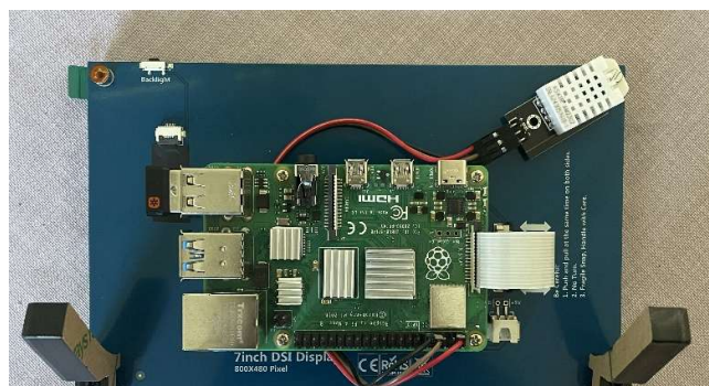
Abbildung 2: Rückseite Display, mit Raspberry Pi & DHT22
